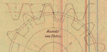
Detail der Zahnstange und des Triebrades.
