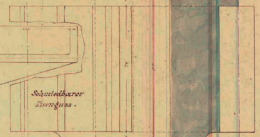
Detail der Zahnstange und des Triebrades.
